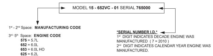
6<sup>th</sup>-7<sup>th</sup> Space: **DRIVE CONFIGURATION** blank - Direct Drive
